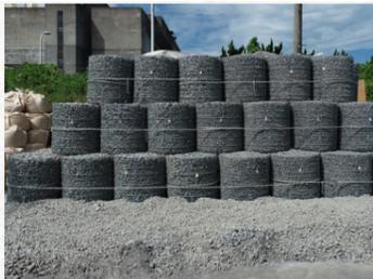
かご丸くん碎石型の金網の鉄線は耐久性の高いアルミ合金めっきを使用しているため、大型土のうと同程度の作業量で恒久的な据付が可能です。また、複数個のかご丸くんにチェーンを用いて緊縛ができるため高い安定性を誇ります。
