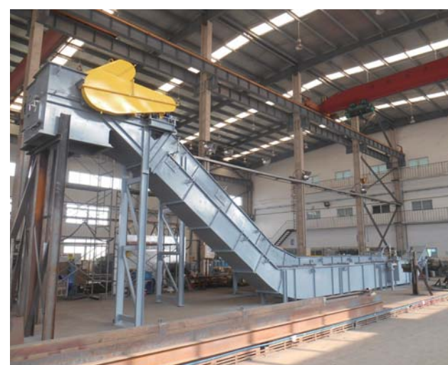
スラグ搬送用コンベヤ
